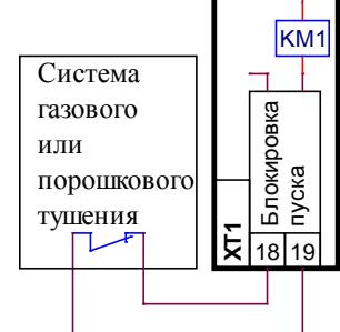
На рис. слева показан пример схемы блокировки шкафа управления вентилятором общеобменной вентиляции при включении вентилятора противодымной вентиляции.
